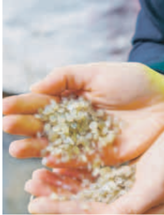
Kasutatud kilest toodetud kile- graanulid, millest saab toota uusi kiletooteid.
