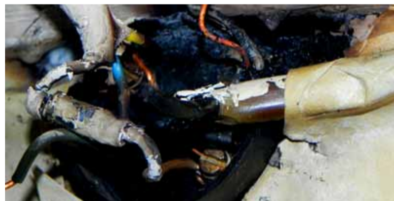
Tulekahju võib alguse saada lühise tõttu ülekuumenenud harukarbist. Foto: Põhja päästetöökeskus
