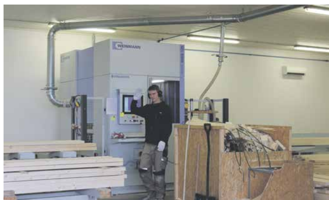
Osa Eestis unikaalsest Wienmanni täisautomaatsest järkamisliinist ja selle operaator.
