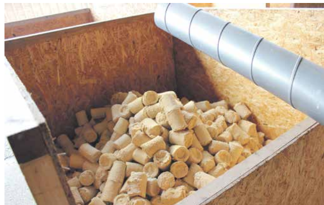
Puitbrikket tootmisjääkidest, mis kütab Lehetu tehast.
