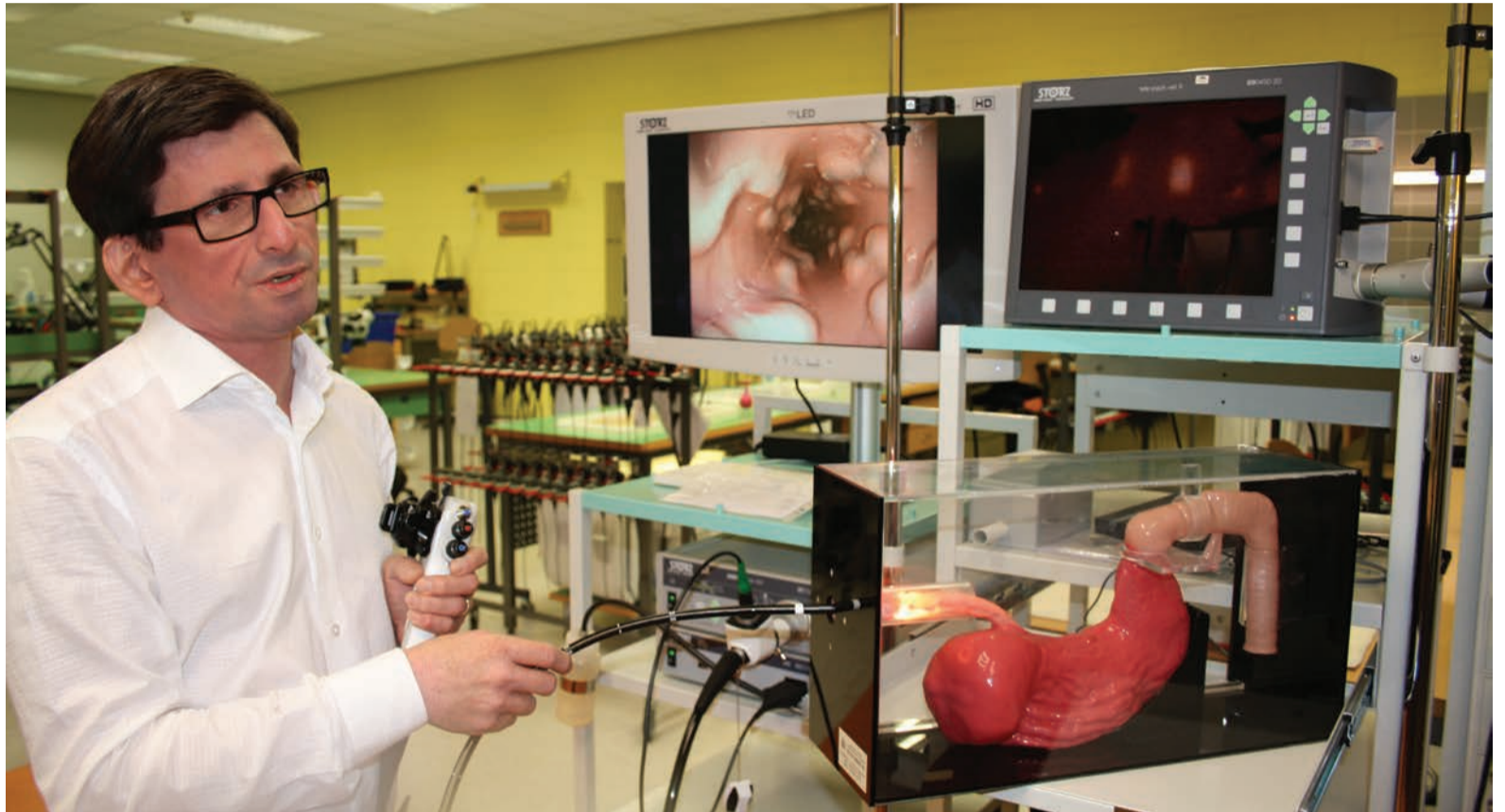
Ettevõtte juht Tõnis Pilvisto näitab inimese mao mulaaži, suunates peenikese sondi (no nii poolesentimeetrise läbimõõduga) imiteeritud söögitoru kaudu maku. Sond ise on liikuv ja paindub ja selle sees on kaabel, mille ühes otsas on kaamera ja teine on ühendatud monitori külge.
